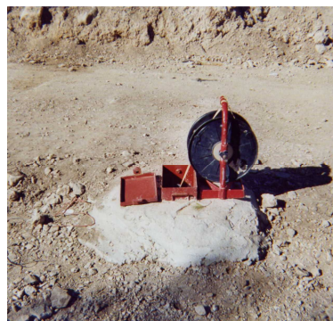
Figura 6.- Hidronivel utilizado para control en un sondeo piezométrico.
